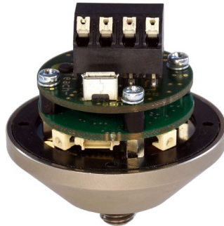
Bild 1: Anschlussklemmen und USB-Buchse im VS11
