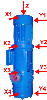
Bild 14: Messorte an Maschinen mit vertikalem Rotor
