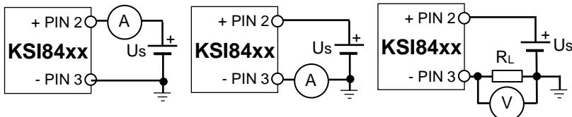
Der Sensorstrom kann entweder direkt mit einem in Reihe geschalteten Strommessgerät gemessen werden oder indirekt durch Messung der Spannungsabfalls über den Lastwiderstand  $R_L$  an PIN 3.
