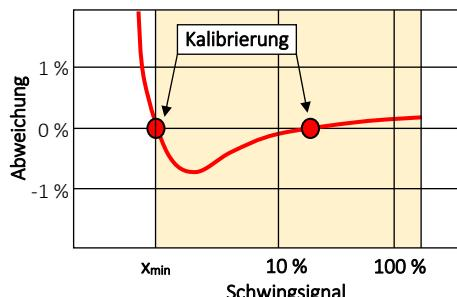
Bei Schwingungsamplituden, die **größer** als die maximale Aussteuerung  $x_{max}$  sind, steigt der Sensorstrom nicht mehr an. Er bleibt konstant auf **22 mA**<sup>1)</sup>. Es muss ein Sensor mit einem größeren Messbereich (Range) verwendet werden.
