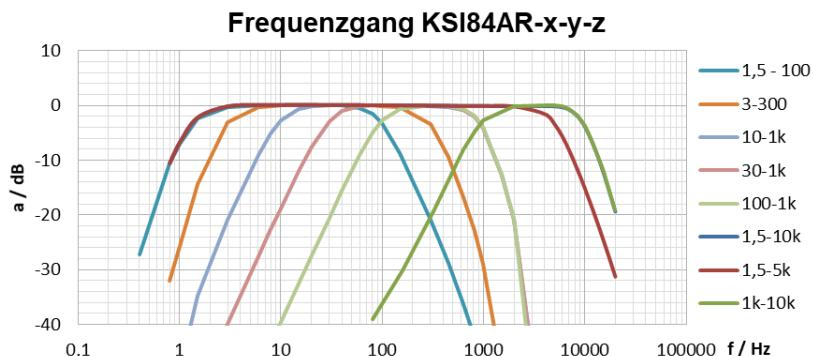
Das HP-Filter der Sensortypen für die Messgröße **Geschwindigkeit** besitzt eine Dämpfung von -50 dB/Dekade im Sperrbereich, das LP-Filter eine Dämpfung von -40 dB/Dekade.
