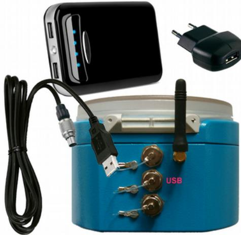
Bild 69: USB-Anschluss, USB-Netzgerät, Power Bank (z.B.15 Ah) und USB-Kabel
