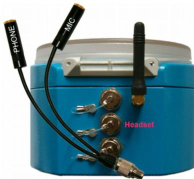
Bild 46: Headset-Adapter und Anschlussbuchse
