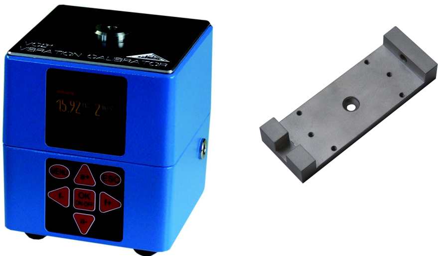
Bild 28: Schwingungskalibrator VC21 und Kalibrieradapter 144
