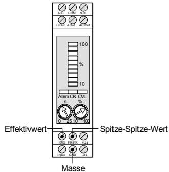
Bild 25: Gleichspannungsausgänge
