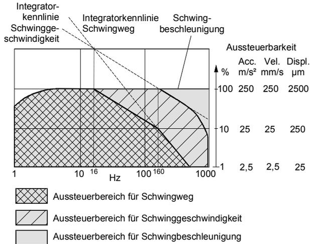
Bild 16: Aussteuerbarkeit der Integratoren als Funktion der Frequenz
