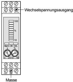
Bild 28: Wechselspannungsausgang
