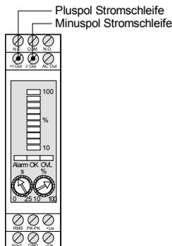
Bild 24: Stromschleifenanschluss
