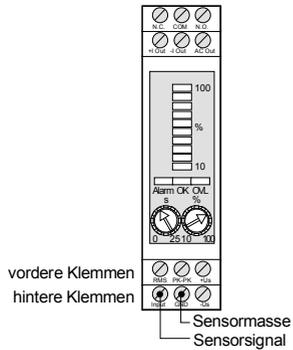
Bild 12: Sensoranschluss
