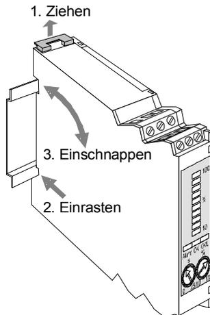
Bild 8: DIN-Schienenmontage
