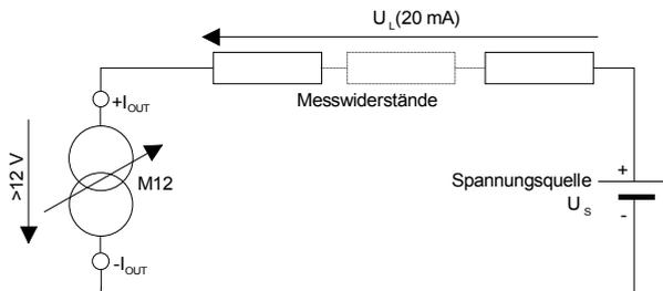
Bild 23: Stromschleife
